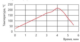
Приводимые рекомендации по профилю применимы к большинству сплавов Sn/Pb, включая Sn/Pb/Ag. Эти данные можно использовать в качестве общих рекомендаций при установке профиля оплавления для сплавов Sn/Pb. Для более подробной информации обратитесь к техническому листу на данный продукт.
